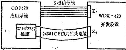
图4 COP420联机方式示意图
