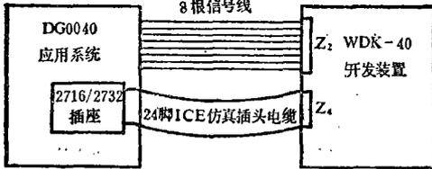
图5 DG0040联机方式示意图
