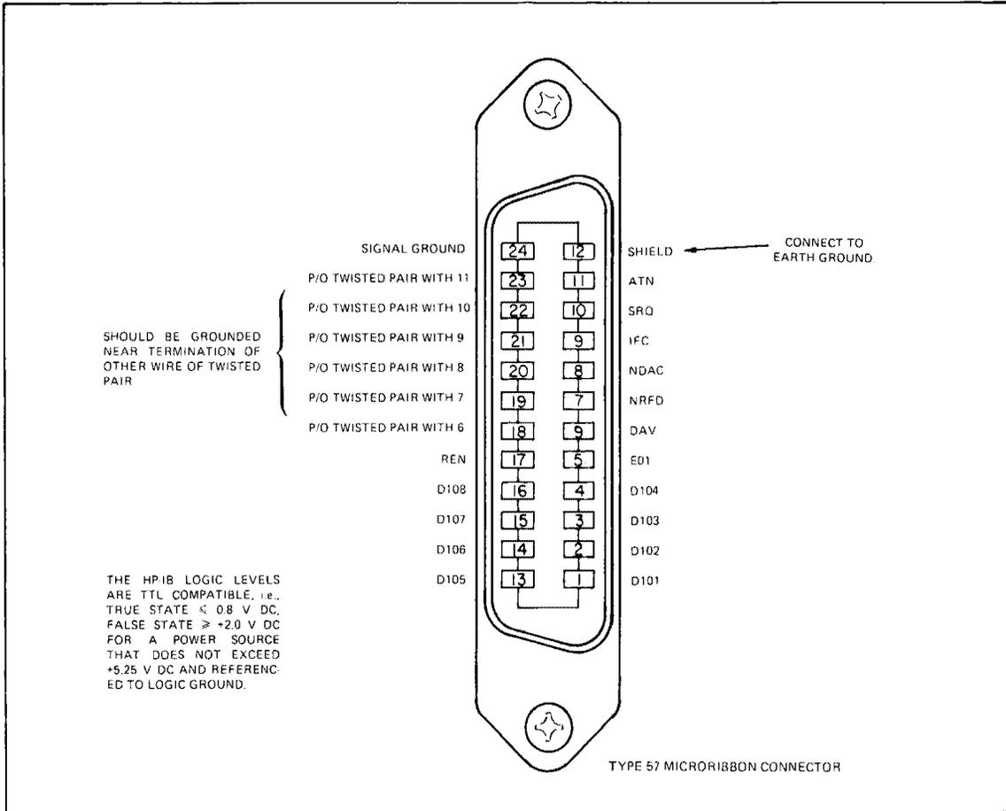
Figure 2-4. HP-IB Connector.
