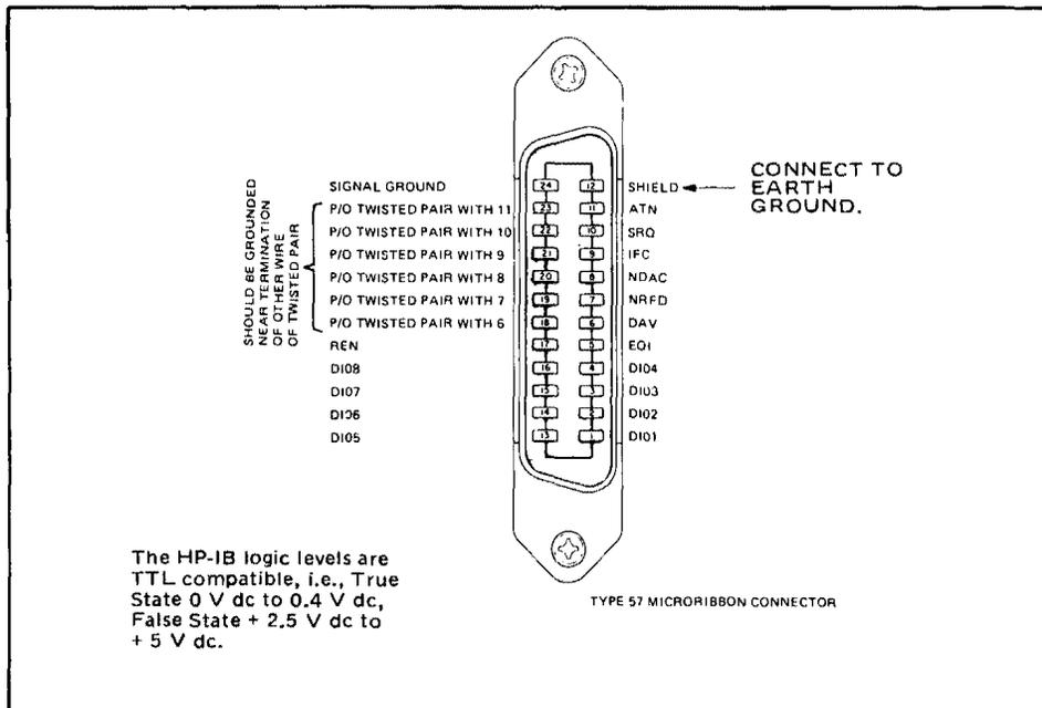
**Figure 3. HP-IB Connector.**
