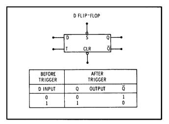
Figure 8-6. D Flip-Flop
